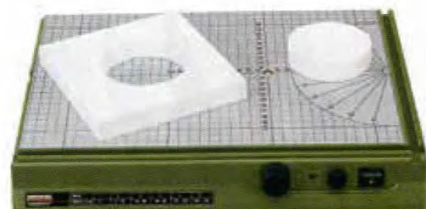
環形切割可通過一個簡單有效的方法來實現:用螺釘將泡沫塑料固定在工作枱,然後沿著中心旋轉便可進行環形切割。
